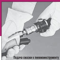
Поддача смазки к пневмоинструменту
